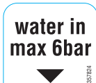
Zbog izbjegavanja oštećenja opreme tlak vode ne smije biti viši od 6 bara.
