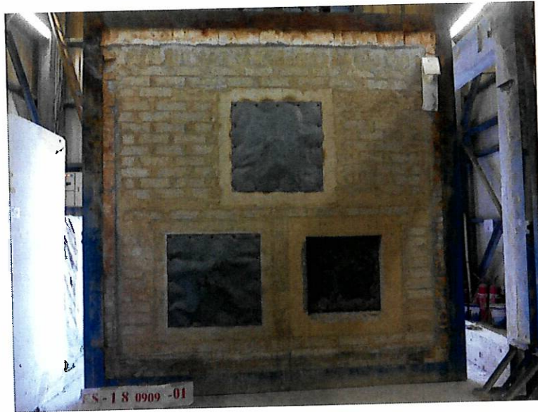
圖 32 測試後試件向火面
