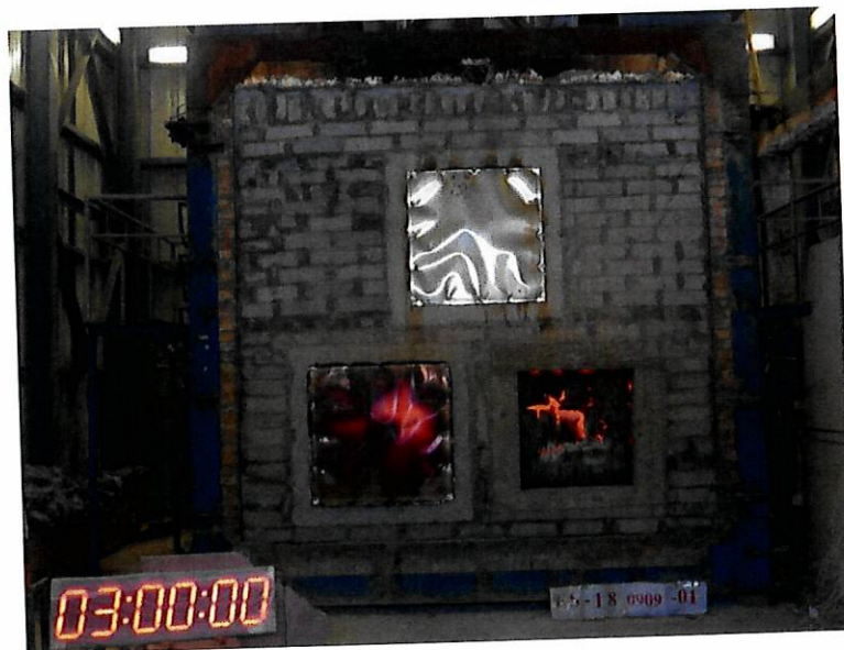
圖 27 測試 180min 後試件背火面
