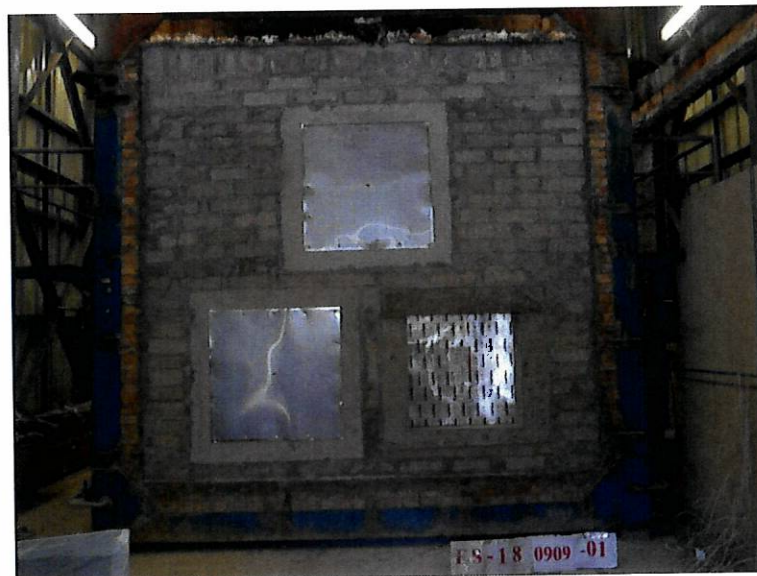
圖 15 測試前試件背火面
