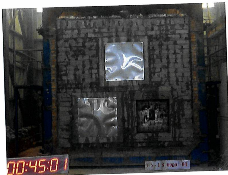
圖 18 測試 45min 後試件背火面
