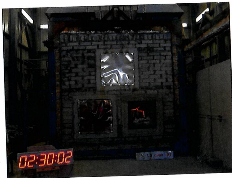
圖 25 測試 150min 後試件背火面
