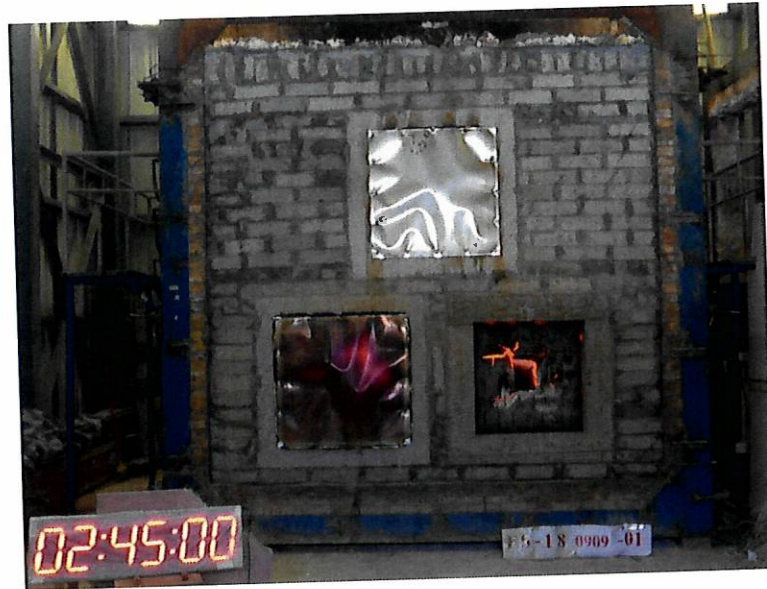
圖 26 測試 165min 後試件背火面
