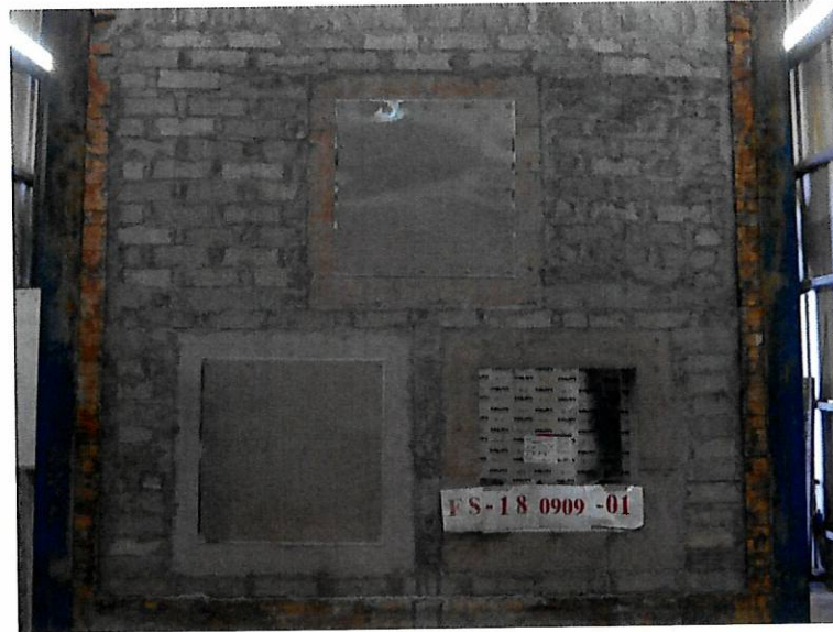
圖 14 測試前試件向火面
