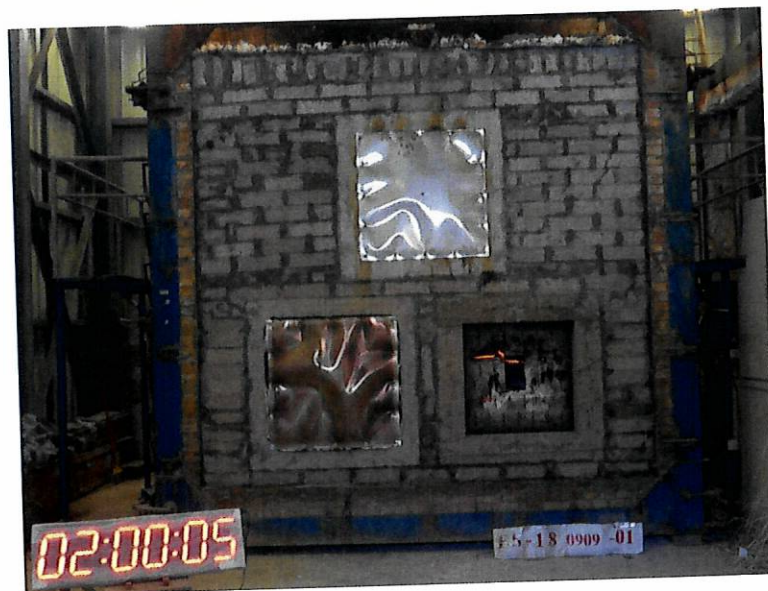
圖 23 測試 120min 後試件背火面
