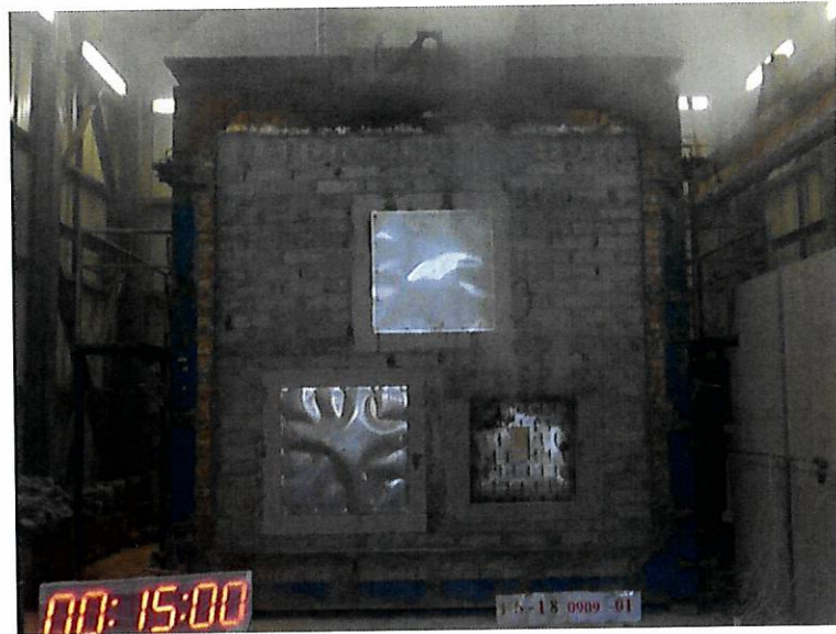
圖 16 測試 15min 後試件背火面
