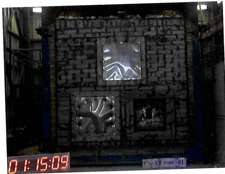
圖 20 測試 75min 後試件背火面
