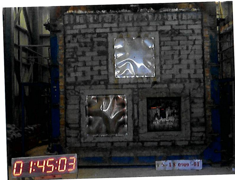
圖 22 測試 105min 後試件背火面
