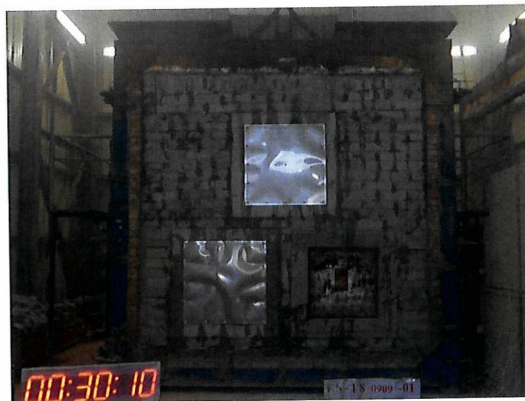
圖 17 測試 30min 後試件背火面
