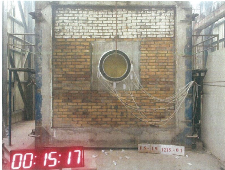
圖 11 測試 15min 後試件背火面
