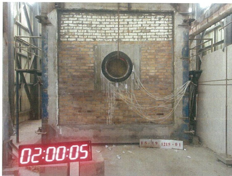
圖 18 測試 120min 後試件背火面
