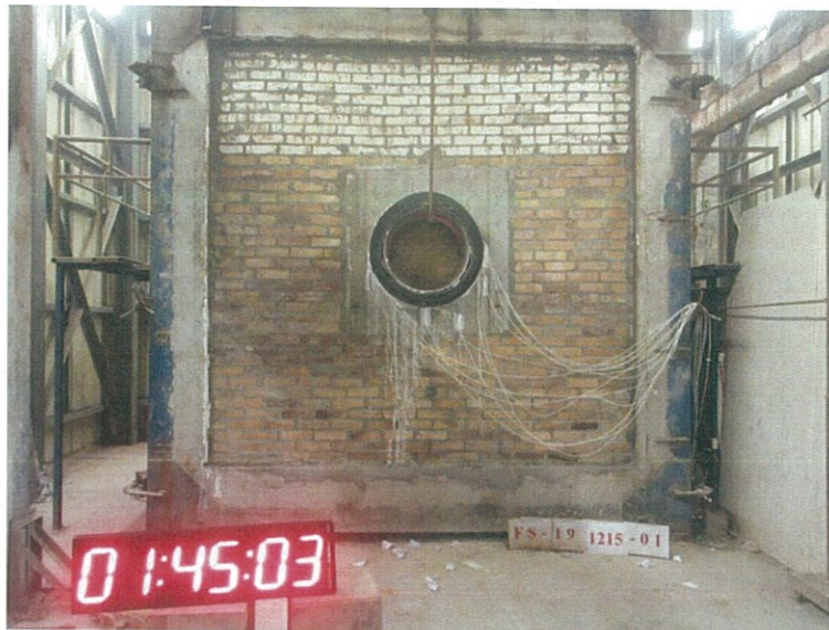
圖 17 測試 105min 後試件背火面
