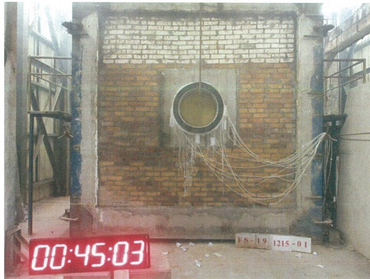
圖 13 測試 45min 後試件背火面
