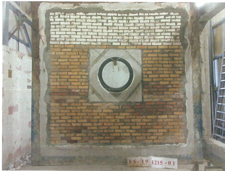
圖 9 測試前試件向火面
