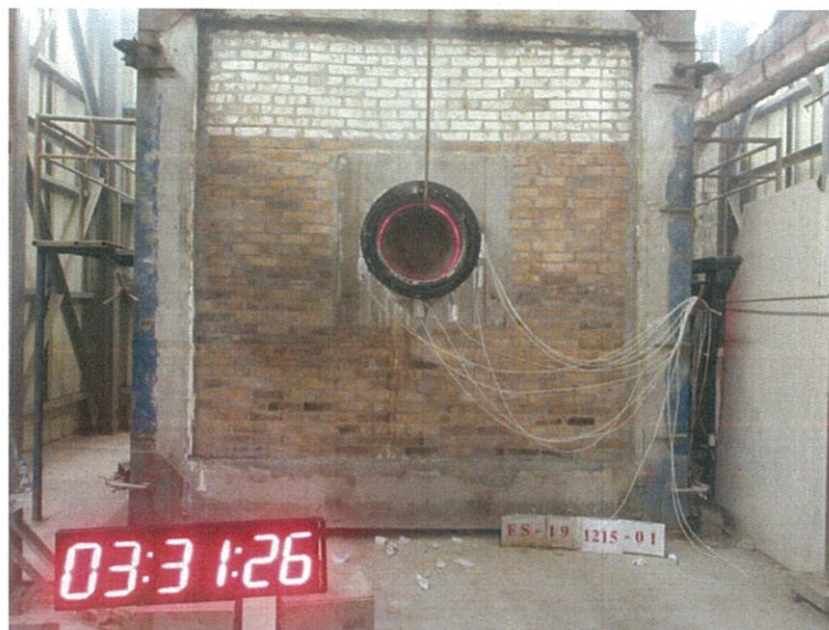
圖 24 測試 210min 後試件背火面
