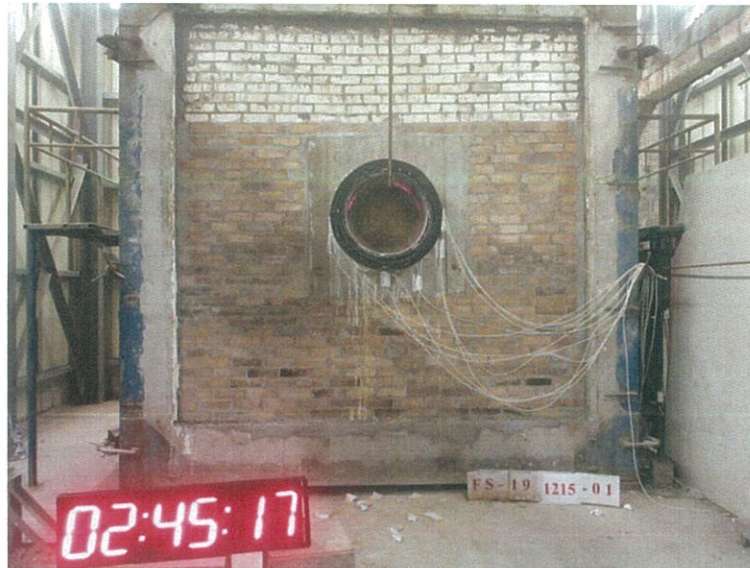
圖 21 測試 165min 後試件背火面
