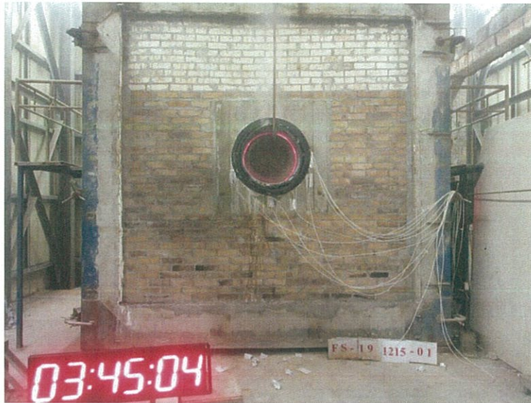
圖 25 測試 225min 後試件背火面
