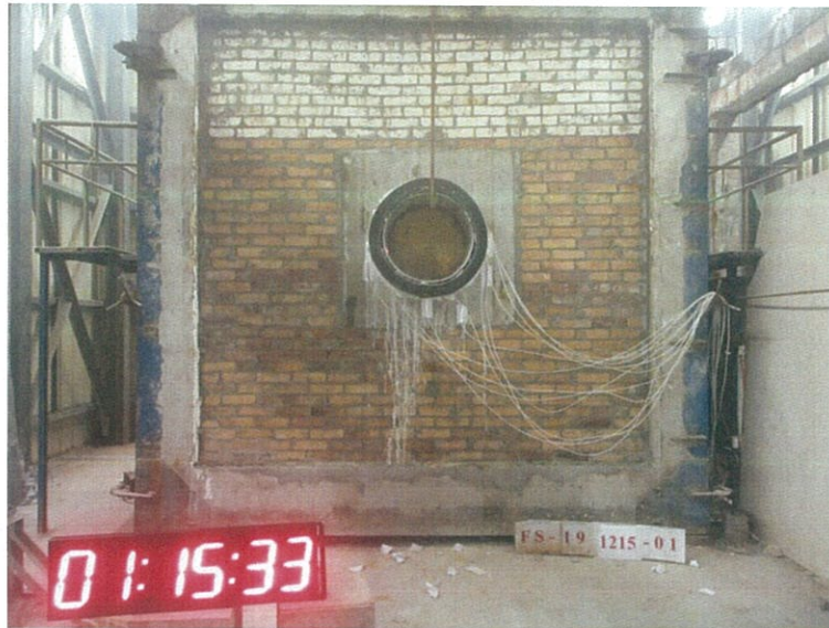
圖 15 測試 75min 後試件背火面
