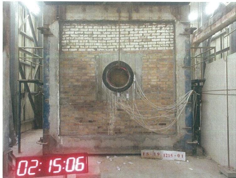
圖 19 測試 135min 後試件背火面
