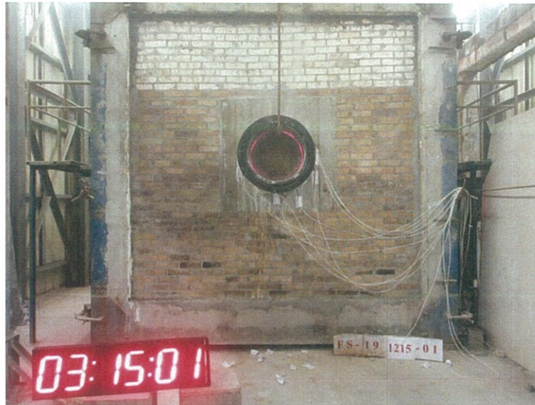
圖 23 測試 195min 後試件背火面
