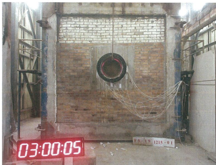
圖 22 測試 180min 後試件背火面
