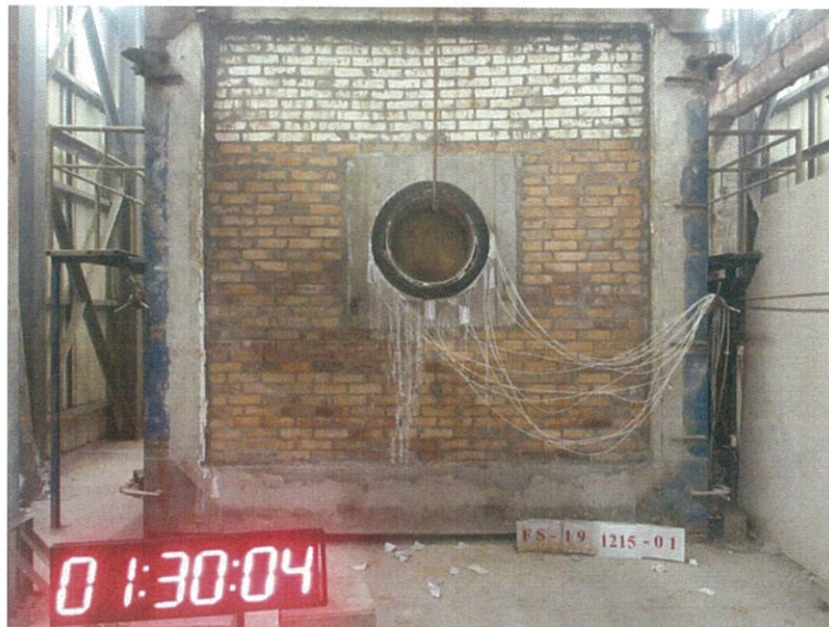
圖 16 測試 90min 後試件背火面
