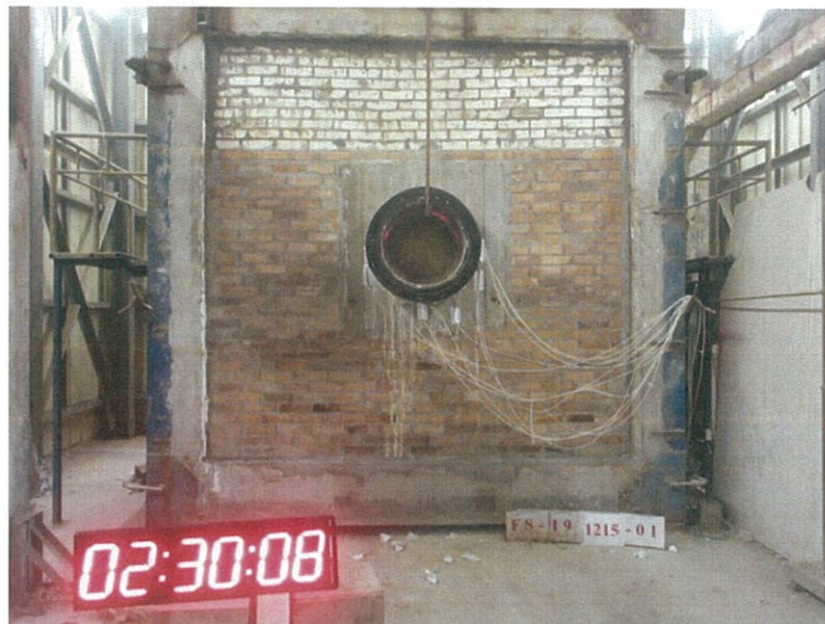
圖 20 測試 150min 後試件背火面
