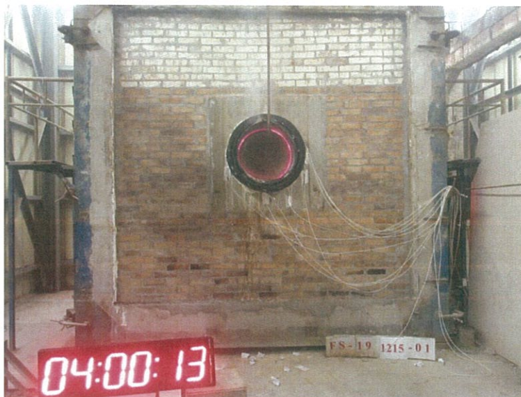
圖 26 測試 240min 後試件背火面
