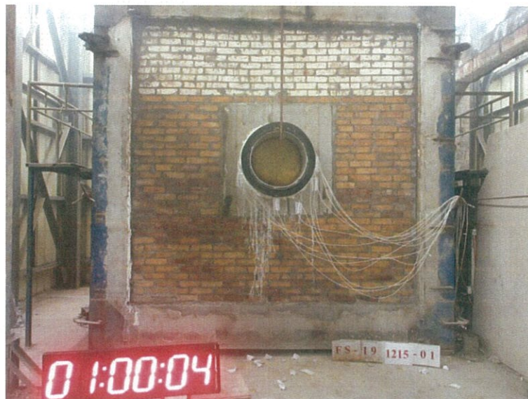
圖 14 測試 60min 後試件背火面
