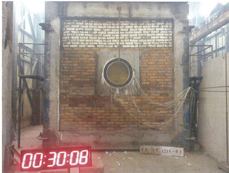
圖 12 測試 30min 後試件背火面
