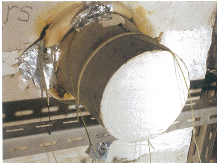
圖 18 測試 180min 時試件背火面防火帶的膨脹情況
