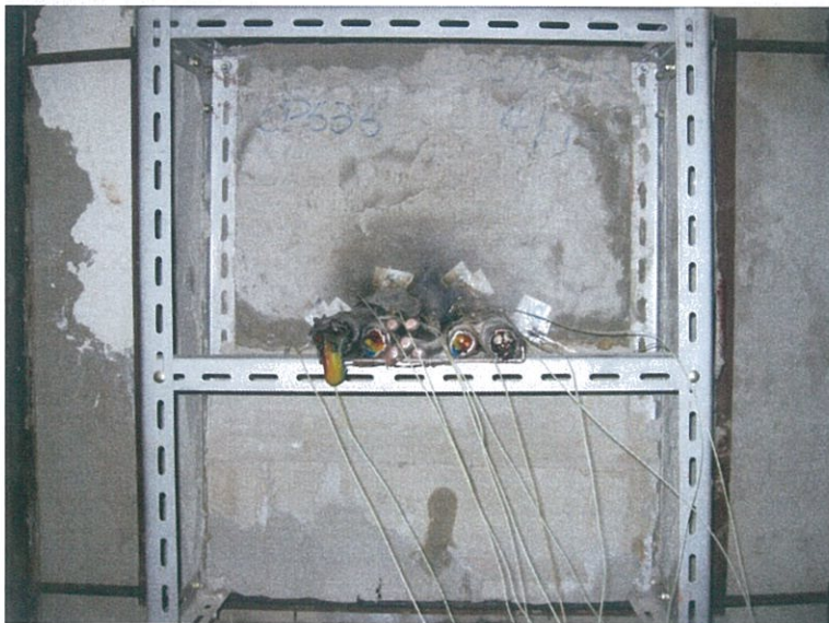
圖 18 測試 240min 時試件背火面
