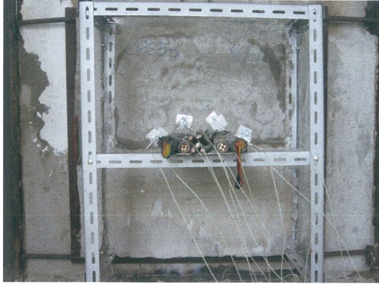
圖 13 測試 120min 時試件背火面
