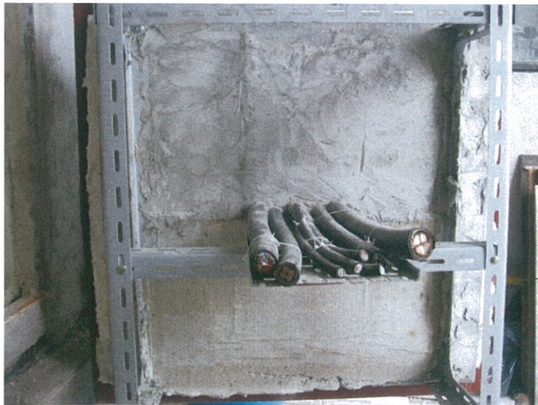
圖 8 測試前試件向火面
