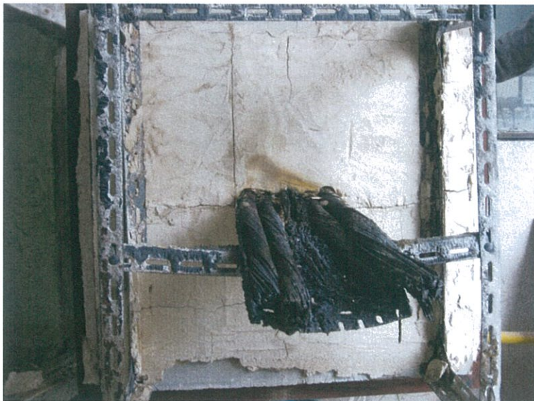
圖 20 測試後試件向火面
