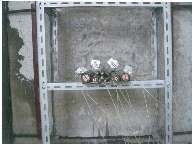
圖 10 測試 30min 時試件背火面
