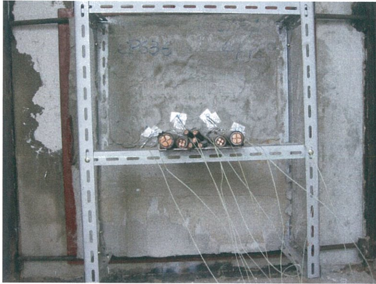
圖 7 測試前試件背火面
