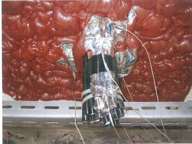
圖 9 試件背火面熱電偶位置
