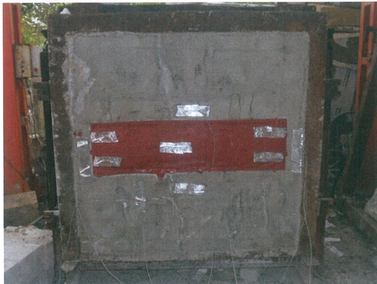
圖 16 測試 180min 時試件背火面
