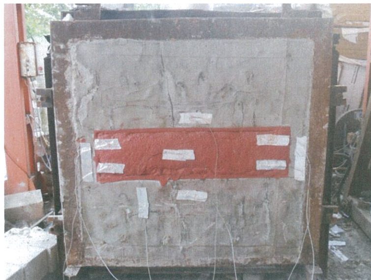
圖 14 測試 120min 時試件背火面
