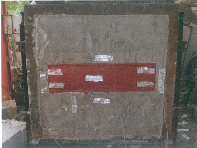
圖 15 測試 150min 時試件背火面
