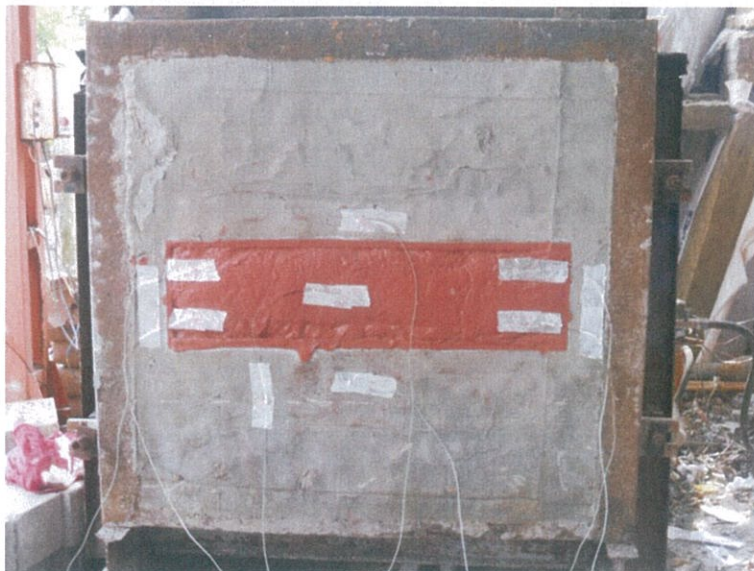
圖 8 測試前試件向火面
