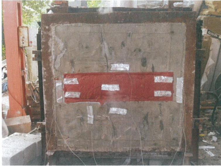
圖 13 測試 90min 時試件背火面
