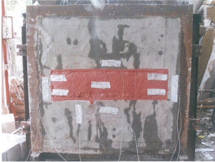
圖 11 測試 45min 時試件背火面
