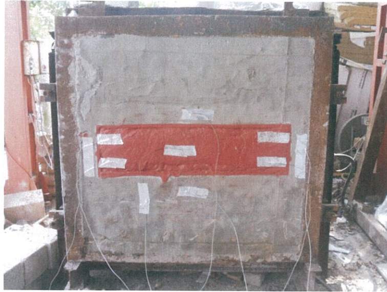
圖 9 測試 15min 時試件背火面
