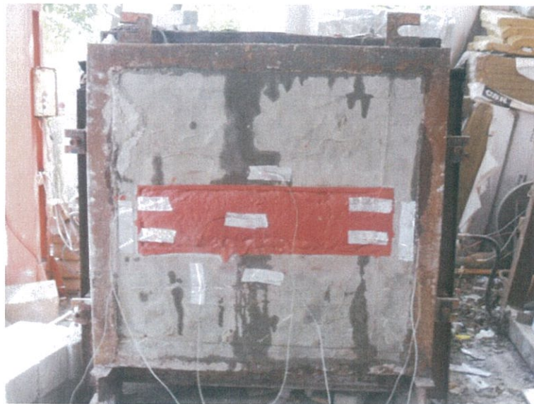
圖 10 測試 30min 時試件背火面
