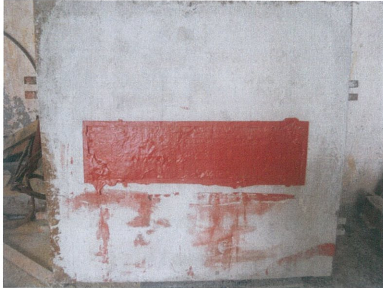
圖 7 測試前試件背火面
