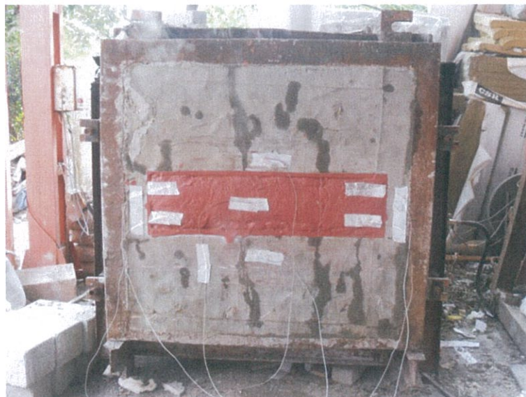
圖 12 測試 60min 時試件背火面
