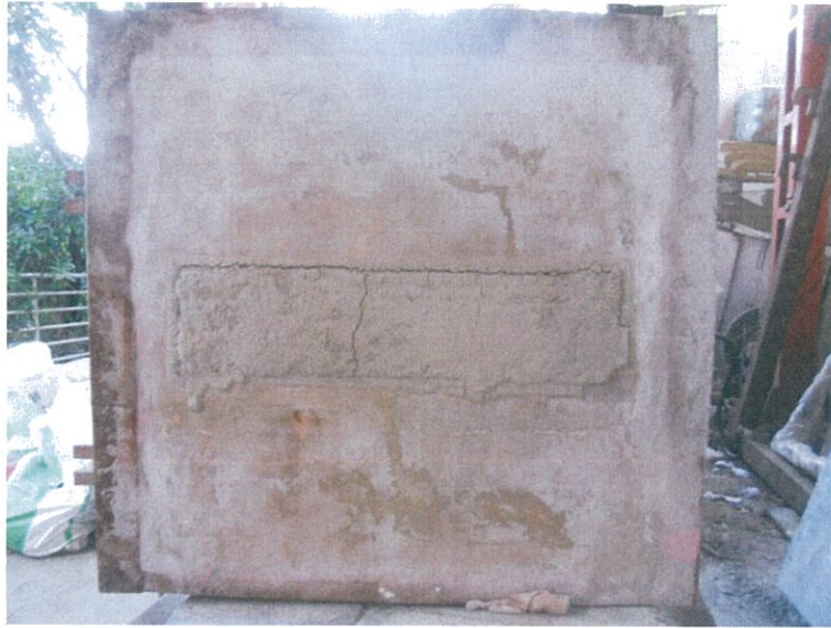
圖 17 測試後試件向火面
