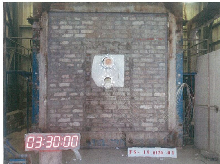
圖 27 測試 210min 後試件背火面
