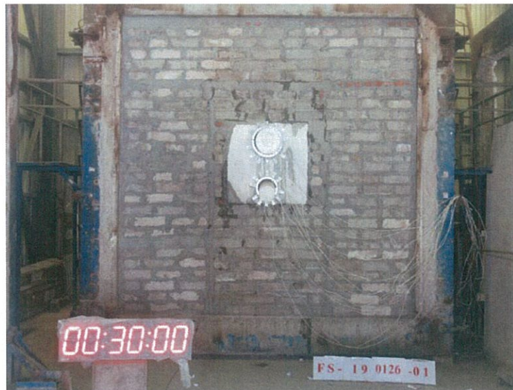
圖 15 測試 30min 後試件背火面
