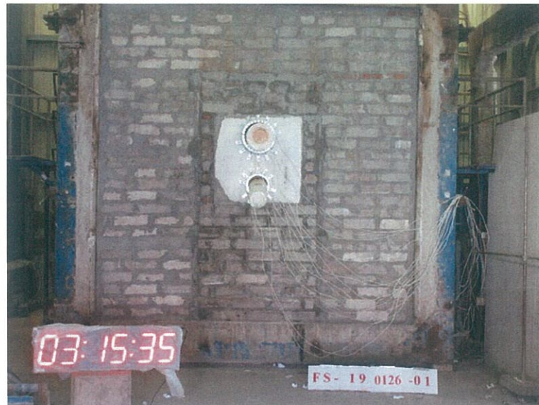
圖 26 測試 195min 後試件背火面
