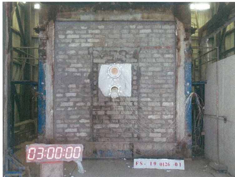
圖 25 測試 180min 後試件背火面
