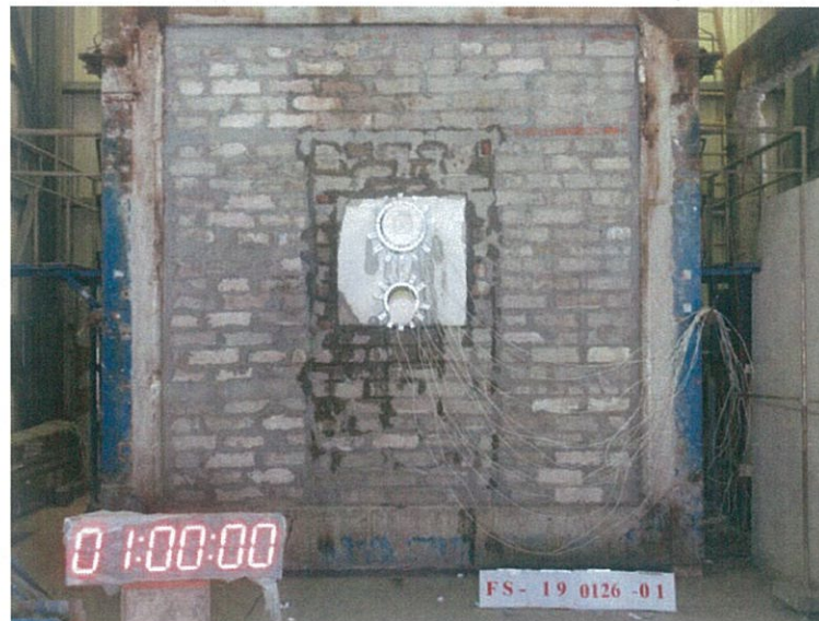
圖 17 測試 60min 後試件背火面
