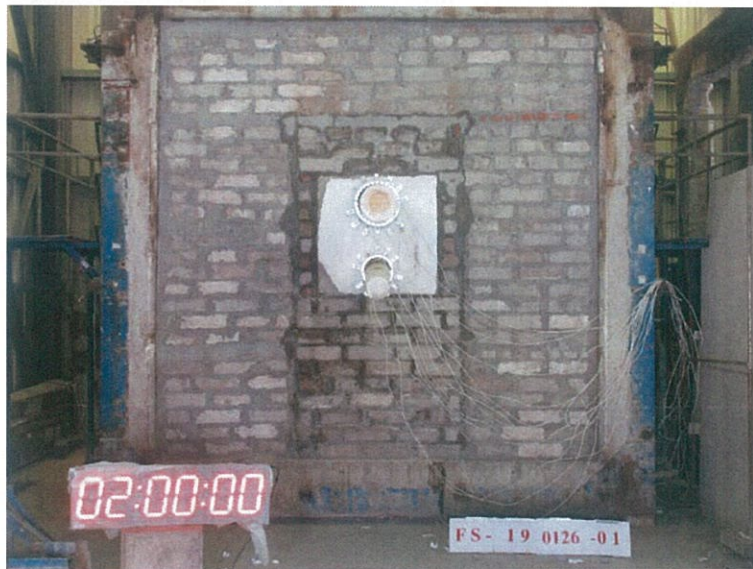
圖 21 測試 120min 後試件背火面
