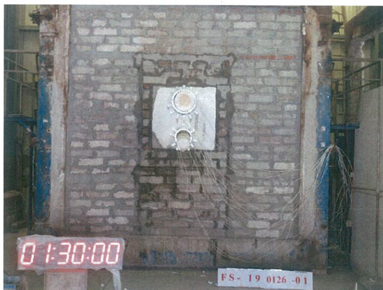
圖 19 測試 90min 後試件背火面
