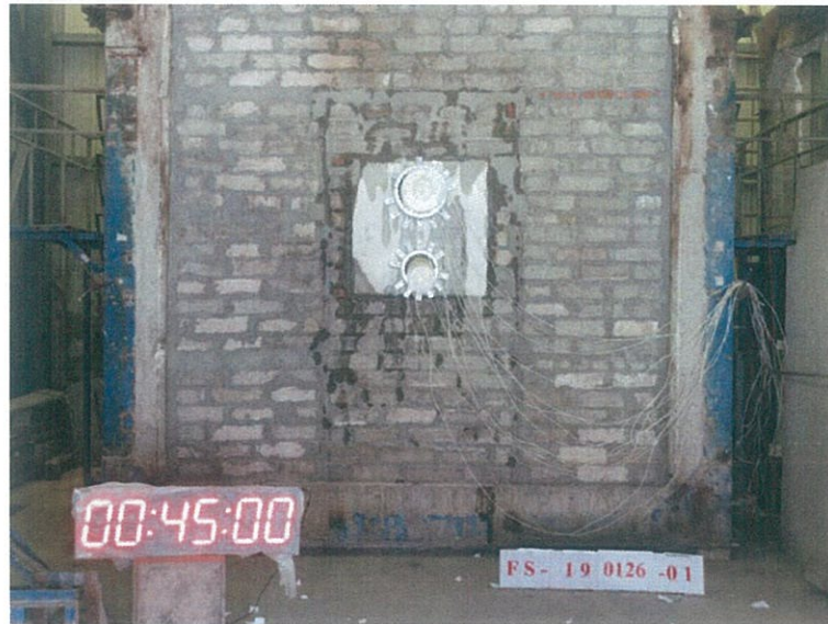
圖 16 測試 45min 後試件背火面
