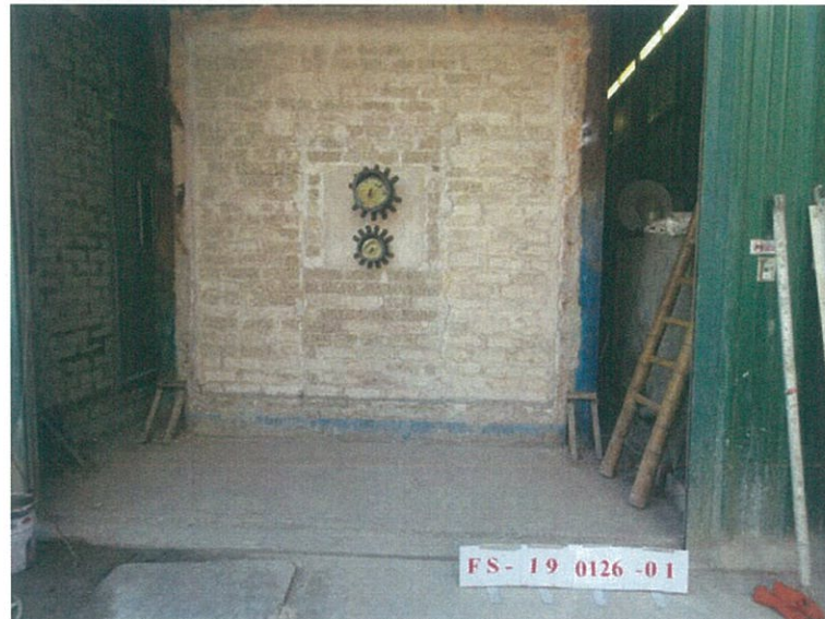
圖 30 測試後試件向火面
