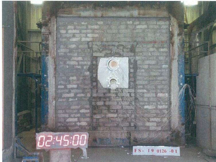
圖 24 測試 165min 後試件背火面
