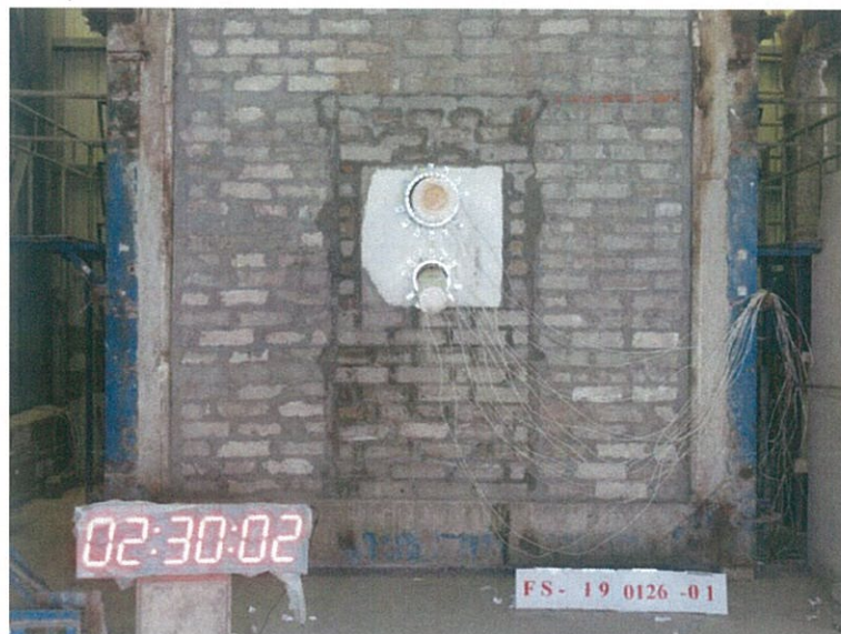
圖 23 測試 150min 後試件背火面
