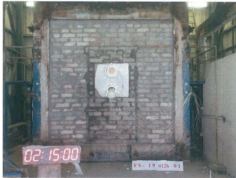
圖 22 測試 135min 後試件背火面
