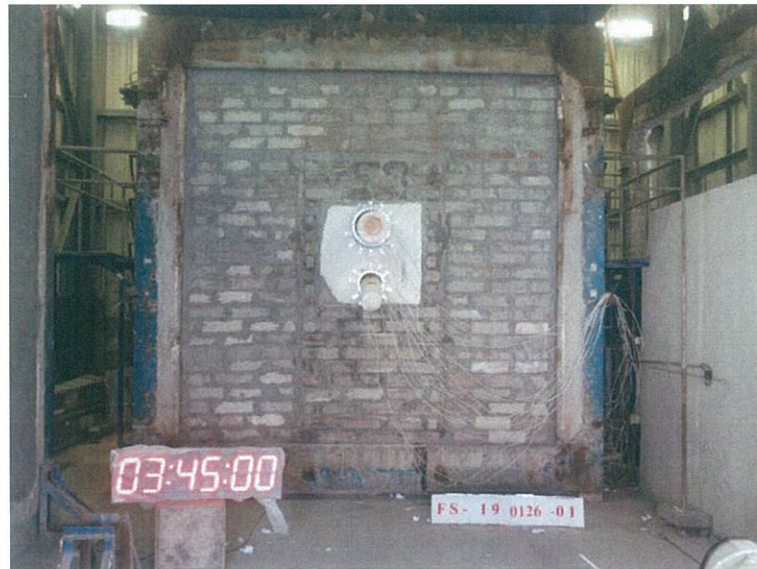
圖 28 測試 225min 後試件背火面
