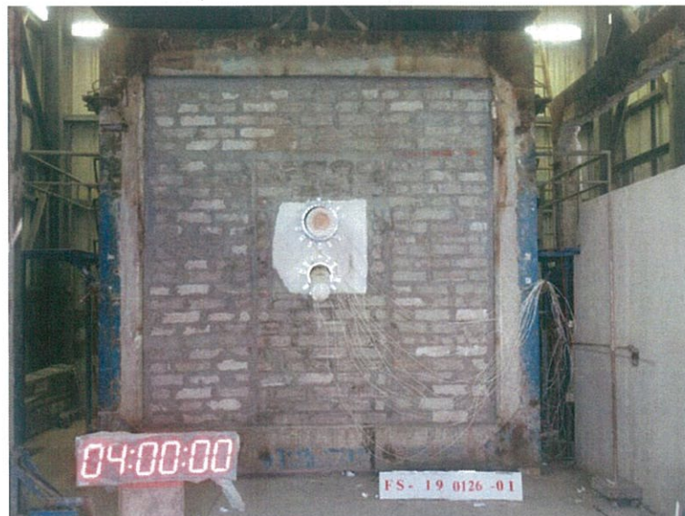
圖 29 測試 240min 後試件背火面
