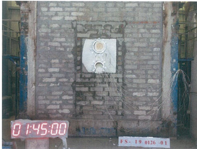
圖 20 測試 105min 後試件背火面
