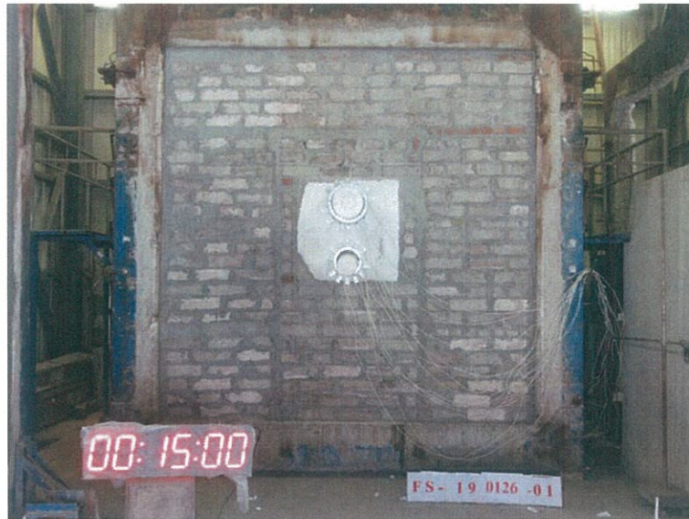
圖 14 測試 15min 後試件背火面
