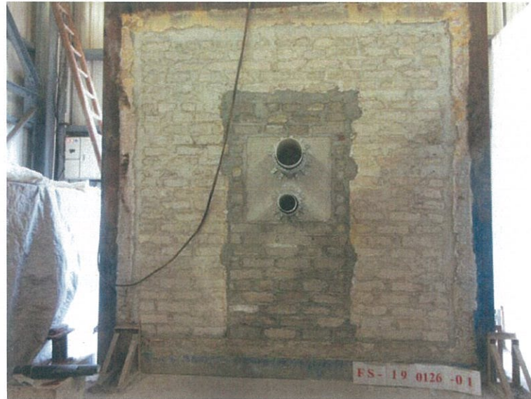
圖 12 測試前試件向火面
