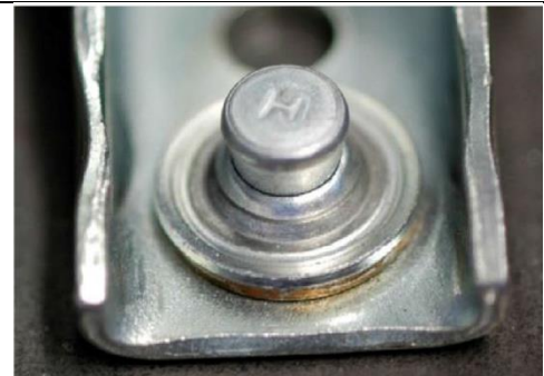
Empreinte du piston clairement visible sur la rondelle supérieure
